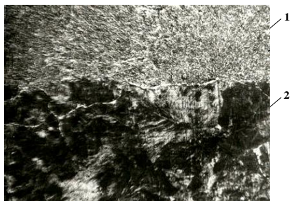
Рис.5. Структура наплавленного металла (1) и зоны термического влияния (2) (светлые зерна - феррит, темные - перлит), х100.
