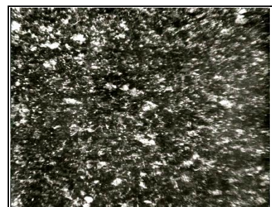
Рис. 6. Микроструктура основного металла на границе с ЗТВ. (светлые зерна – феррит, темные – перлит), х100.
