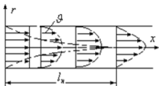
Рис.1. Стабилизация распределения скорости при движении жидкости в трубе.
