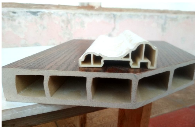
PVX va yog'och chiqindisi asosida yog'och polimer kompozitsion materialning tajriba namunasi.
