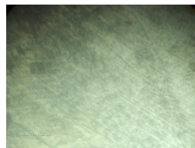
3 расм. Пайвандлаб қопланган металл наъмунасининг микроструктураси (x300)
