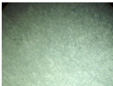
2 расм. Асосий металл наъмуна сининг микроструктураси (x300)
