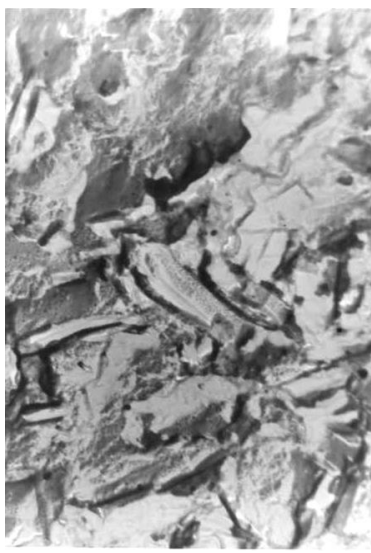
б) Микрофотографии (хэ3200) скола цементного камня неоптимального состава с недостатком воды (образцы 28 сут. возраста)
