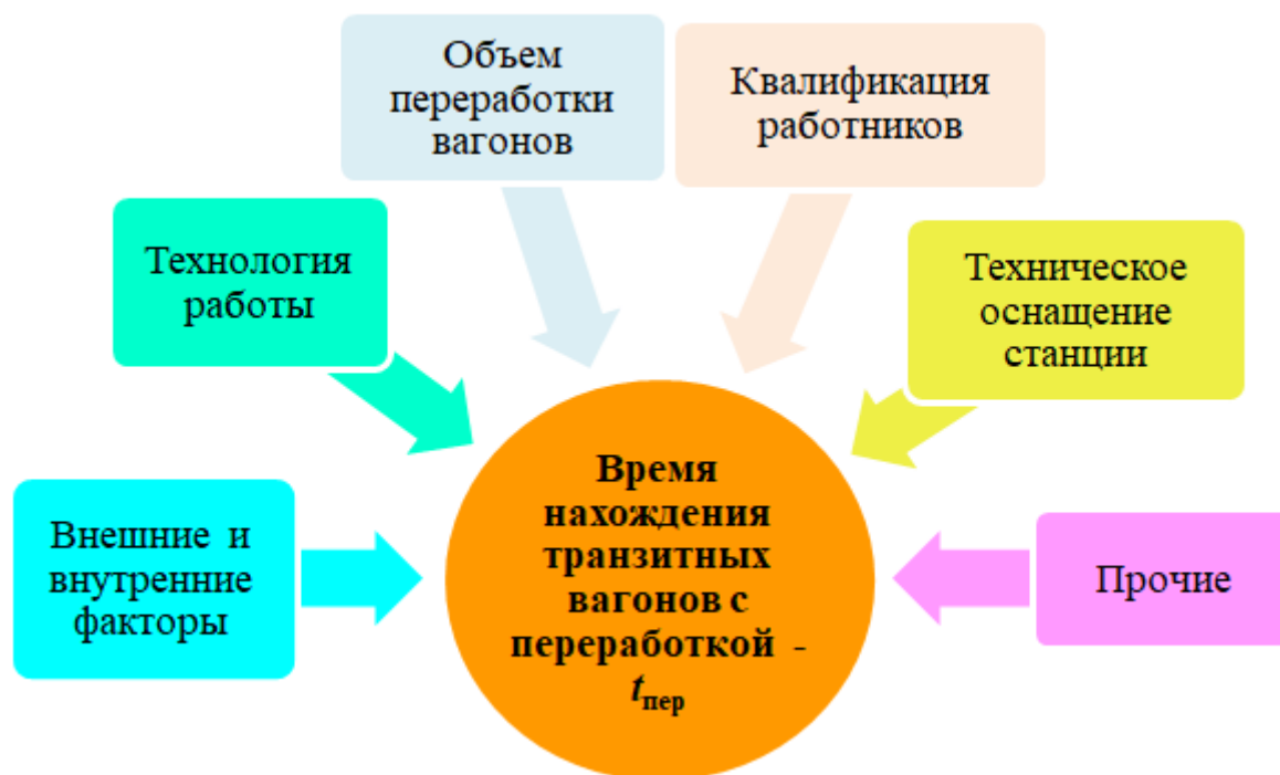
Рисунок 3. Структура факторов, влияющих на норму времени нахождения транзитного вагона с переработкой на сортировочной станции
