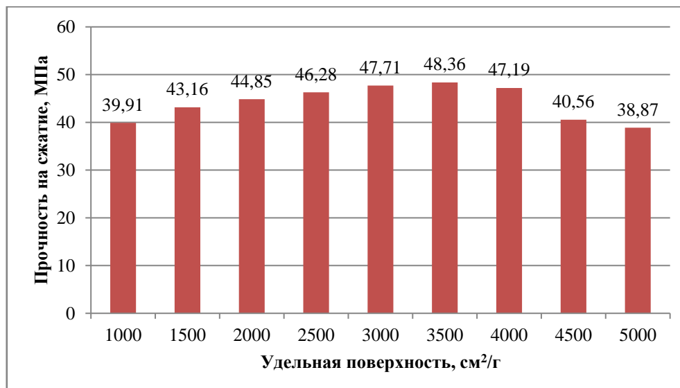
Рисунок 2. Влияние удельной поверхности ЦСП наполнителя на прочность цементного камня (при степени наполнения 30%)
