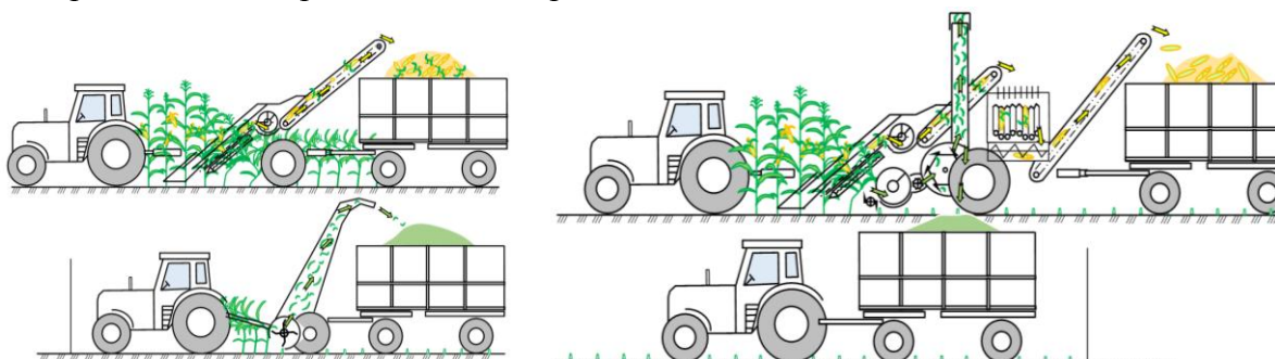
2-расм. а) Сўтанинг ўзини йиғиштириб олиш; б) Сўтани пояси билан бир пайтда йиғиштириб олиш.
