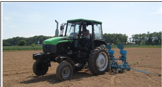
Рис.2. Посевной агрегат, состоящий из трактора с регулируемым клиренсом и сеялки
