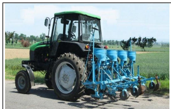
Рис.1. Трактор с регулируемым клиренсом в агрегате с сеялкой СЧХ-4Б.
