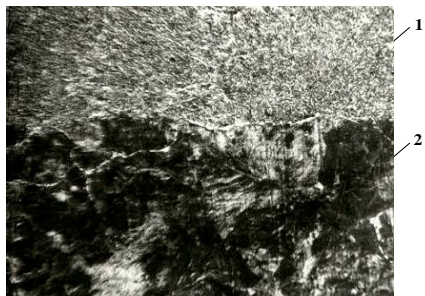
Рис.5. Структура наплавленного металла (1) и зоны термического влияния (2) (светлые зерна - феррит, темные – перлит), x100.
