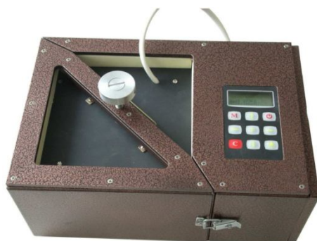
1-расм. Иссиқлик ўтказувчанлик коэффицентини ўлчаш асбоби ИТС-1 нинг ташқи кўриниши.
