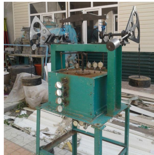
Рис. 2. Схема установки маячков для измерения перемещений, общий вид установки измерительной аппаратуры: 1-объемный лоток размерами A \times B \times H=45 \times 45 \times 30 см; 2-нижний штамп прессиометра; 3- верхний штамп прессиометра; 4-тарированный мелко зернистый песок; 5-крупнозернистый песок; 6-мессуры; h_{I-V} -горизонтально направленные маячки.
