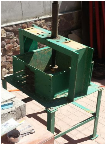
1-рис. Испытательный лоток для модельных испытаний прессиометра.
