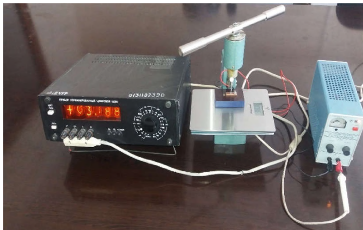
Рис. 2. Внешний вид установки для измерения параметров образцов при воздействии внешнего давления
