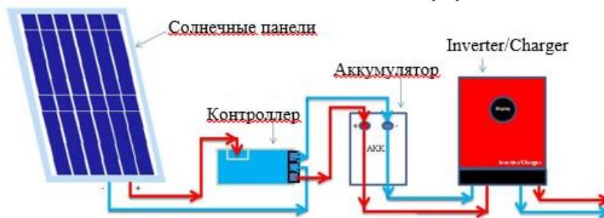
Рис 7. Блок-схема подключения панели и инвертора (аккумуляторная система)
