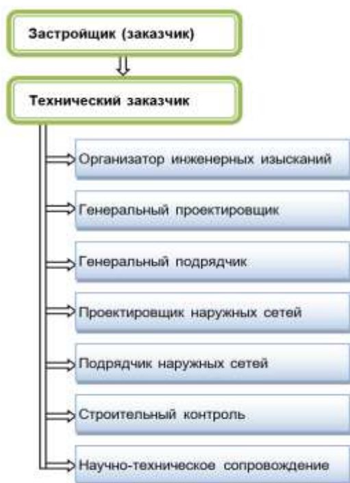
Рис.2. Схема взаимодействия при реализации строительного проекта с заключением контрактов с участниками техническим заказчиком.
