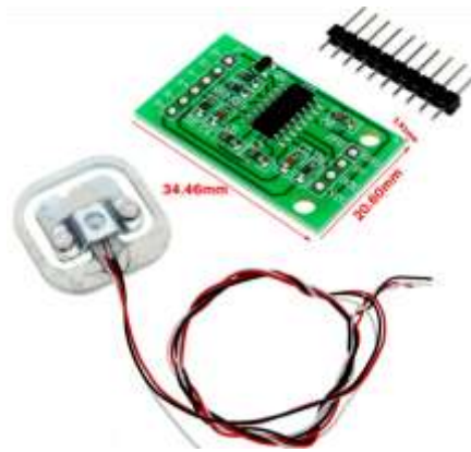
4-расм. Силжиш тензометрик датчиги.
