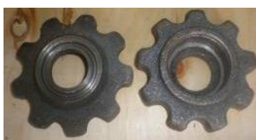
в) каскадли элеватор юлдузчаларини ейилиши кўрсатилган.
