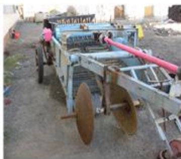
3-расм. а) Дискли лемех ўрнатилган агрегат
