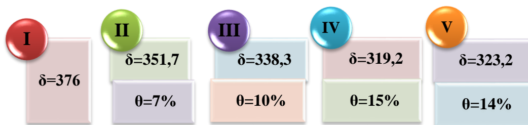
Рис. 2. Объемная плотность \delta (мг/см) и относительное облегчение \theta двухслойного трикотажа
