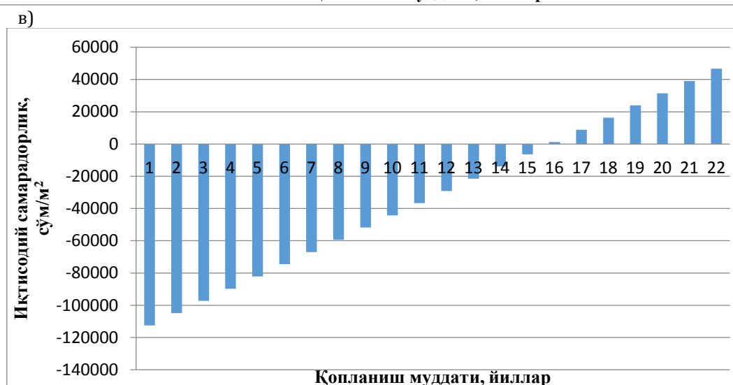
3-расм. Турар-жой бинолари ташқи деворларини термоянгилашга сарф бўладиган инвестицияларни иссиқлик энергия нархини 15%, 20%, 25% га ошгандаги иқтисодий самарадорлик кўрсаткичлари
