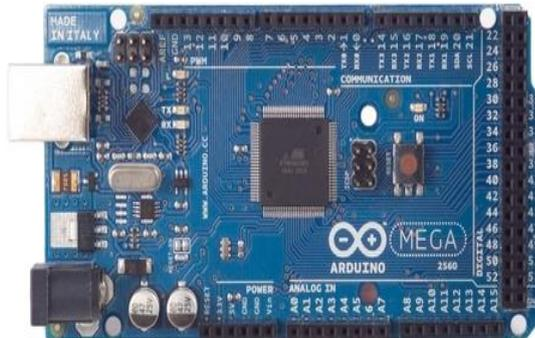
Fig. 9. Arduino Mega
