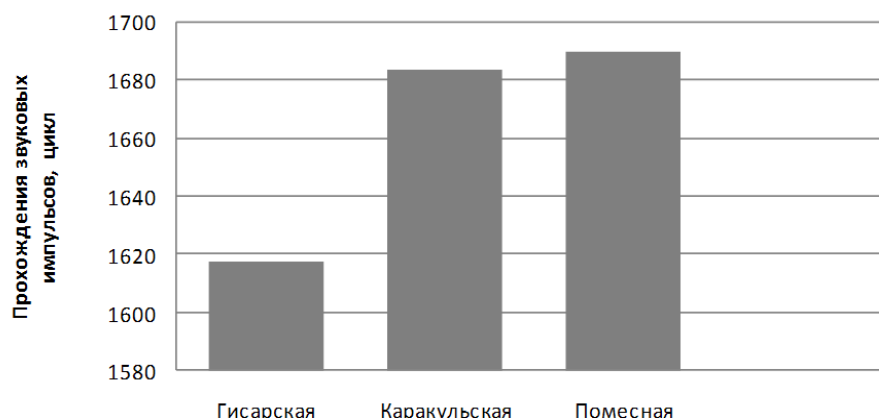
Рис.3. Прохождение звуковых импульсов через шерстяные волокна на приборе ПАН-1
